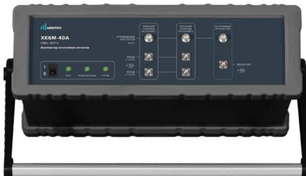
Анализатор источников сигнала ХК6М предназначен для измерения параметров источников сигнала, таких как уровень собственных фазовых и амплитудных шумов, переходных процессов, регулировочных характеристик, а также фазового шума, вносимого цепями СВЧ.
